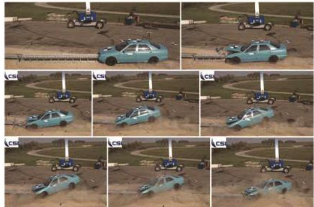
3. Crash test frontale su Ermes , conformemente alla Normativa EN1317. L'urto è stato effettuato con un veicolo da 1.500 kg ad una velocità di 110 km/ora
